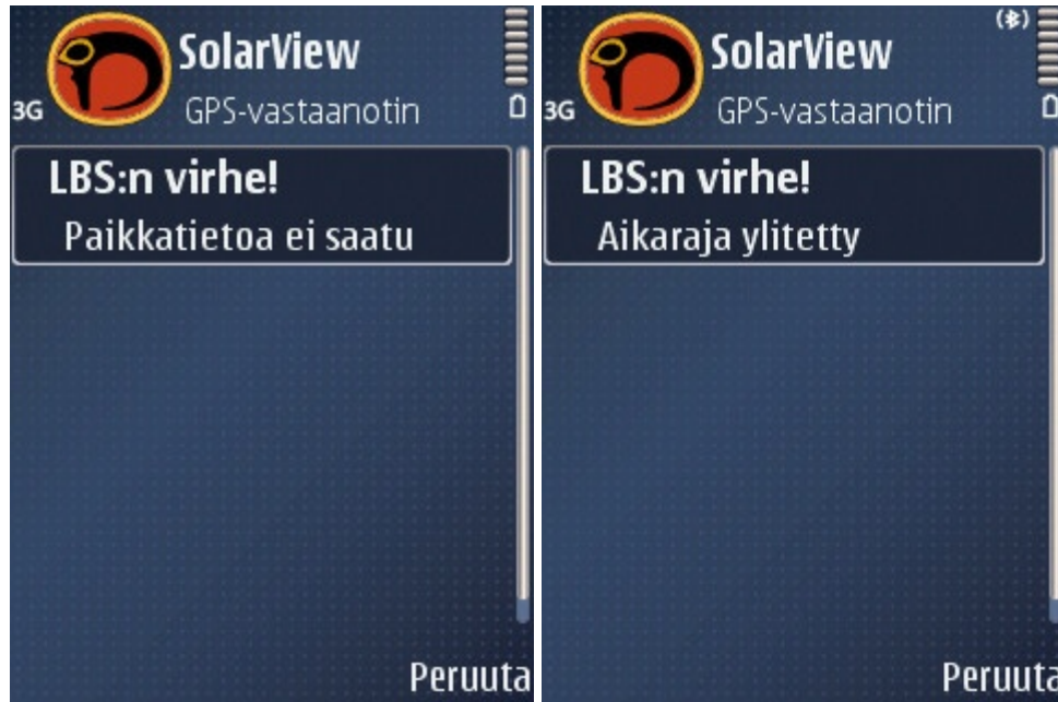
Kuva 18a, 18b. GPS-vastaanottimen virheilmoitukset: 18a) GPS vastaanotinta ei löytynyt. 18b) Paikkakoordinaatteja ei saatu määriteltyä kolmessa minuutissa.
