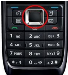
Imagen 2. En este modelo de teléfono, la tecla de navegación (rodeada con un círculo rojo) funciona como las flechas.
